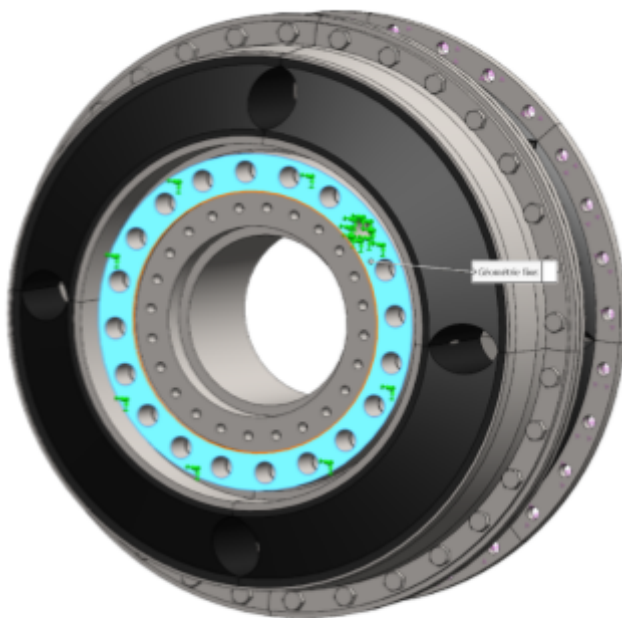
Fig. 5 Accouplement modélisé avec une face bloquée (face bleue)
