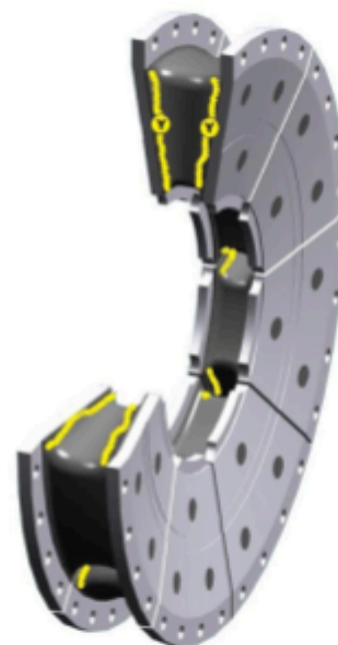
Fig. 4 Sections « T » avec fissures dans la zone Y (traits jaunes)
